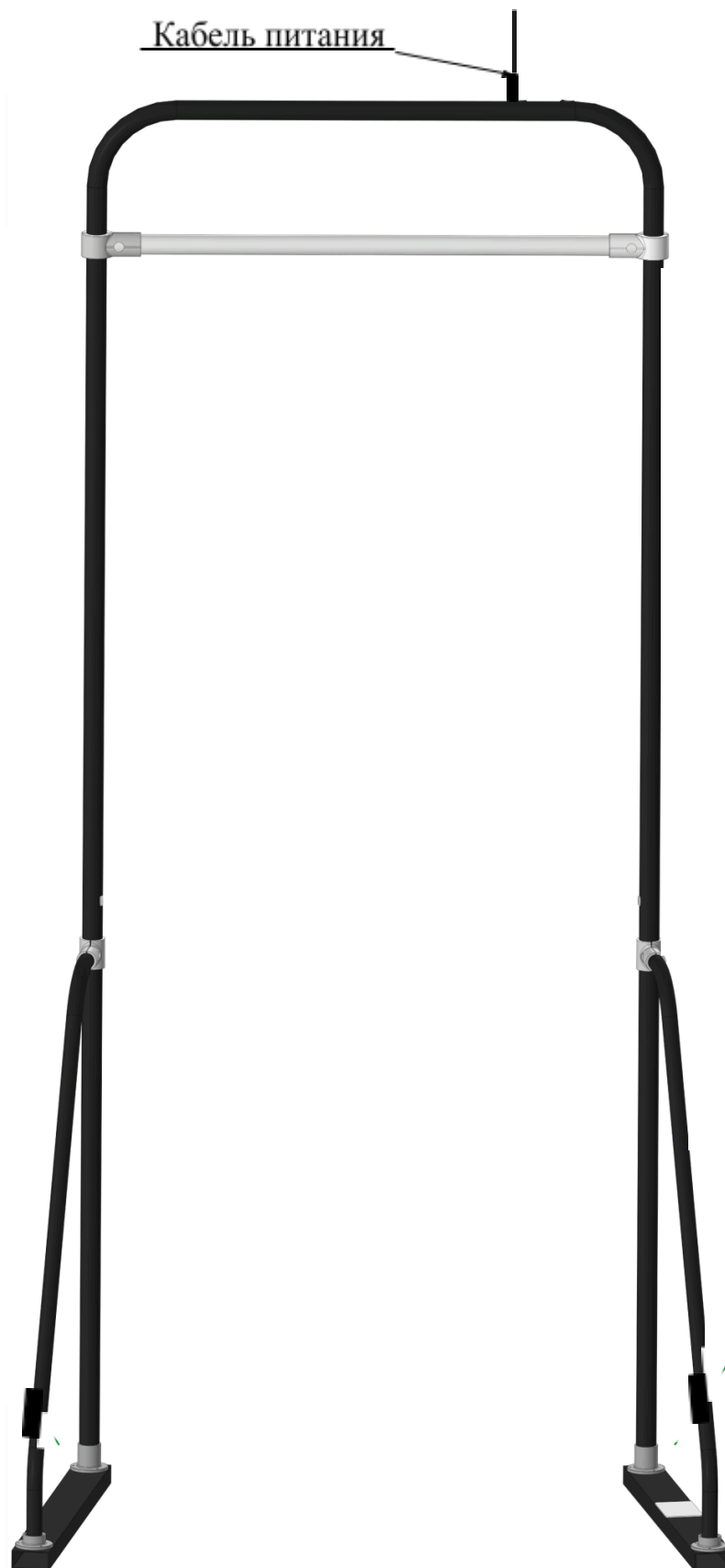
Рисунок 2.2 – Рекомендуемое подключение блока питания (адаптера)
