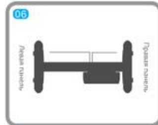
06 Подключите кабели от электронного блока к обеим панелям.
