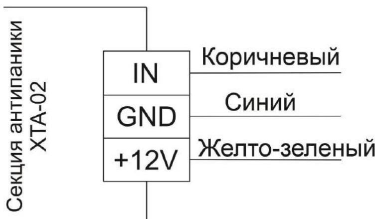
Рисунок 8.1 Назначение проводов секции Антипаника «ХТА-02»
